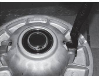
Hakenende des Werkzeugs einführen.
