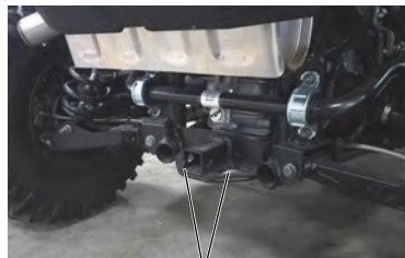
2 hintere Befestigungspunkte (oder Abschleppöse)
